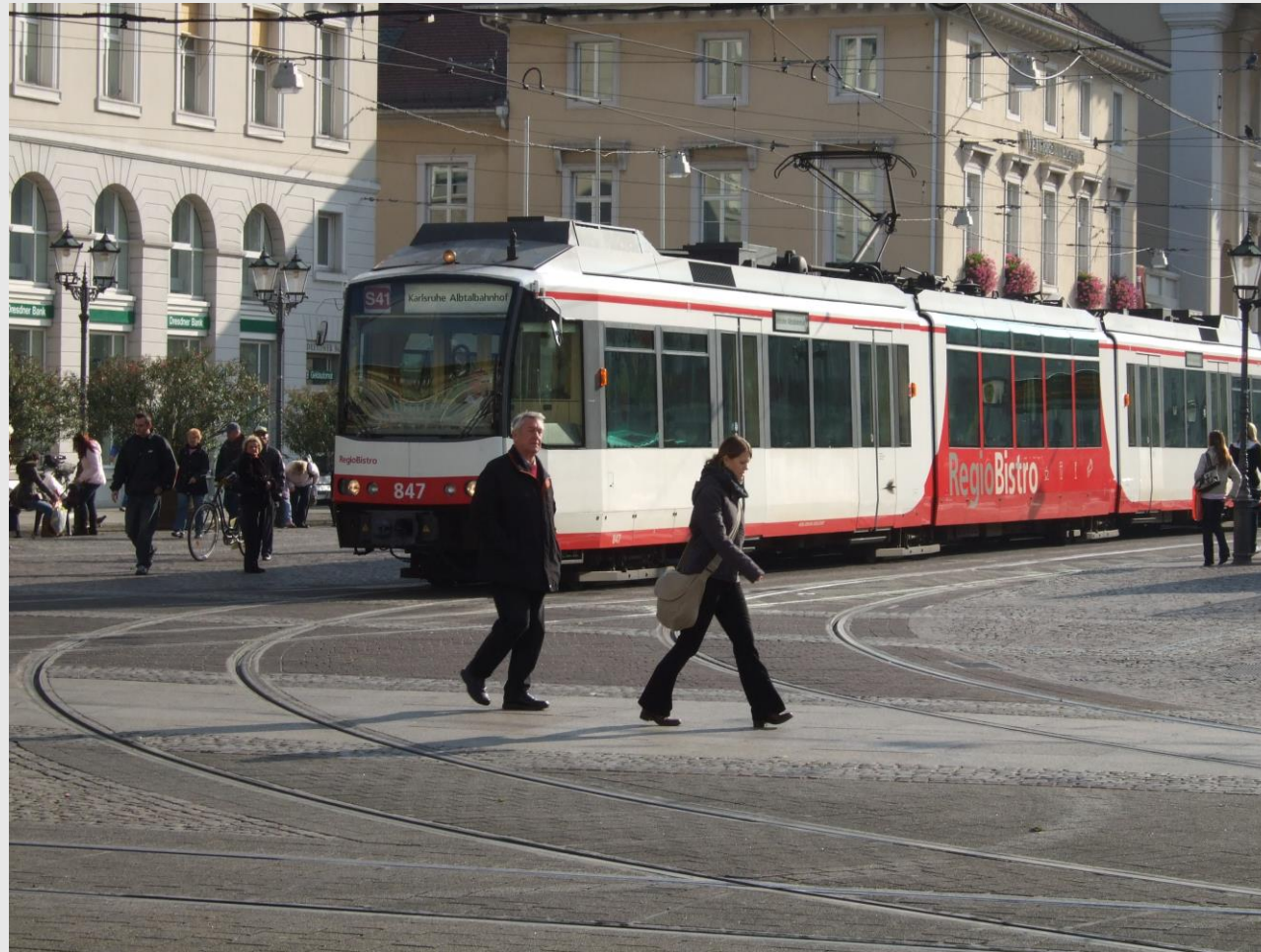
GT 8-100 2S Karlsruhe, mit 750 V DC in der Stadt oder 15 kV WS aus der DB - Fahrleitung [1]
