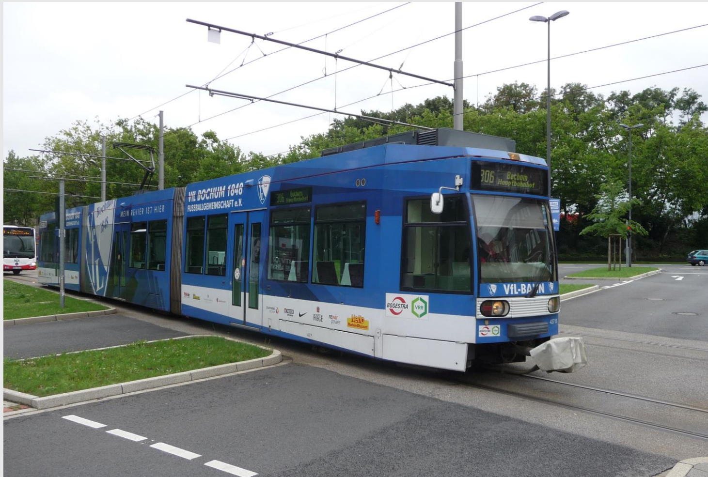
70%-Niederflurfahrzeug: MF6D der Bogestra 1992 (Siemens)
