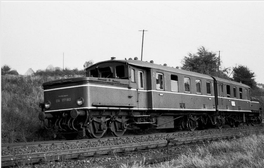
ETA 178 Preußen 1907 Bleibatterie 118 kg/kWh
